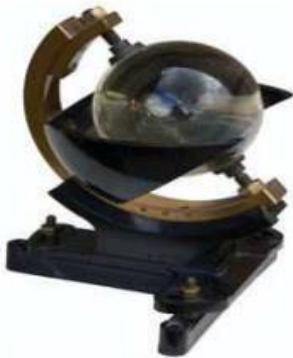
Figure (I 7.a):Héliographe de Campbell Stokes
